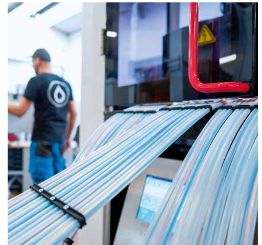
Auf Basis des digitalen Zwillings produziert das Wire Terminal in einer Stunde einen kompletten Datensatz für einen Schaltschrank.
